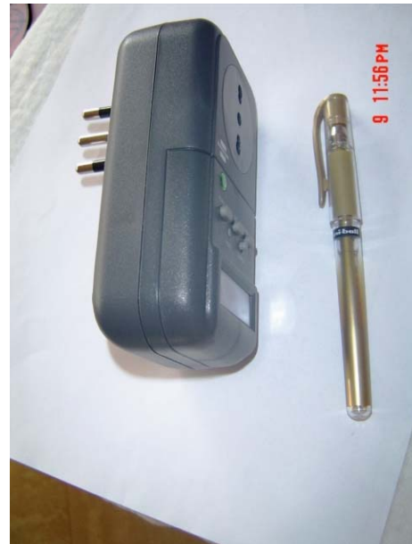
Foto 11. Pamje e aparatit mates multifunksional Tip “brennenstuhl” PM-230
