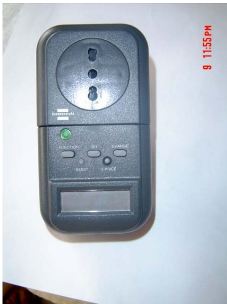
Foto 11. Pamje e aparatit mates multifunksional Tip “brennenstuhl” PM-230
